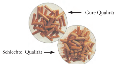
Abb. 10: Vergleich von Pellets mit guter und schlechter Qualität (Bild: Umdasch, Amstetten Österreich).
